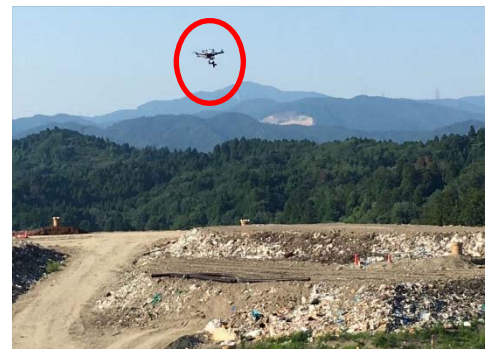
図 6-9 デジタル写真計測による現地作業と解析作業の概要例 5)
