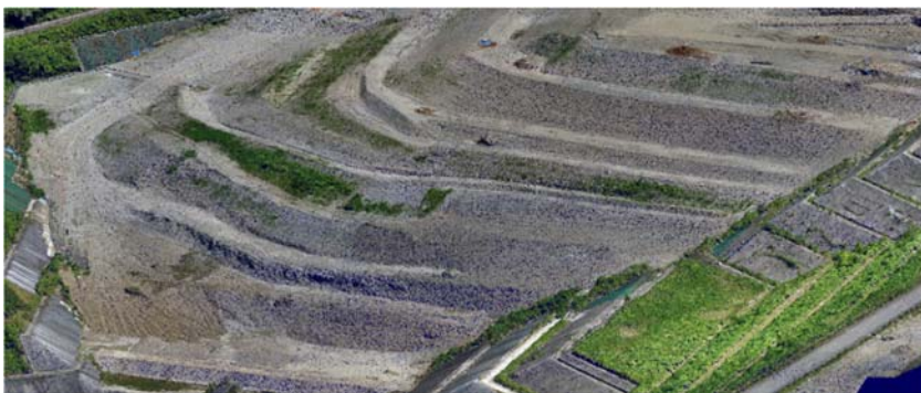
図 6-10 UAVによる最終処分場三次元測量の例
